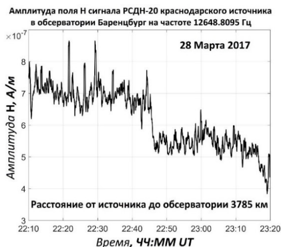
Рис. 11. Амплитуда напряженности магнитного поля сигнала Краснодарского источника, зарегистрированные в обсерватории «Баренцбург» 28 марта 2017 г. на частоте 12649 Гц
